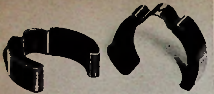
Bild 2. Ionenfallenmagnet aus Eisenoxyd mit Innenbeflockung und Klemmfeder (Valvo)
